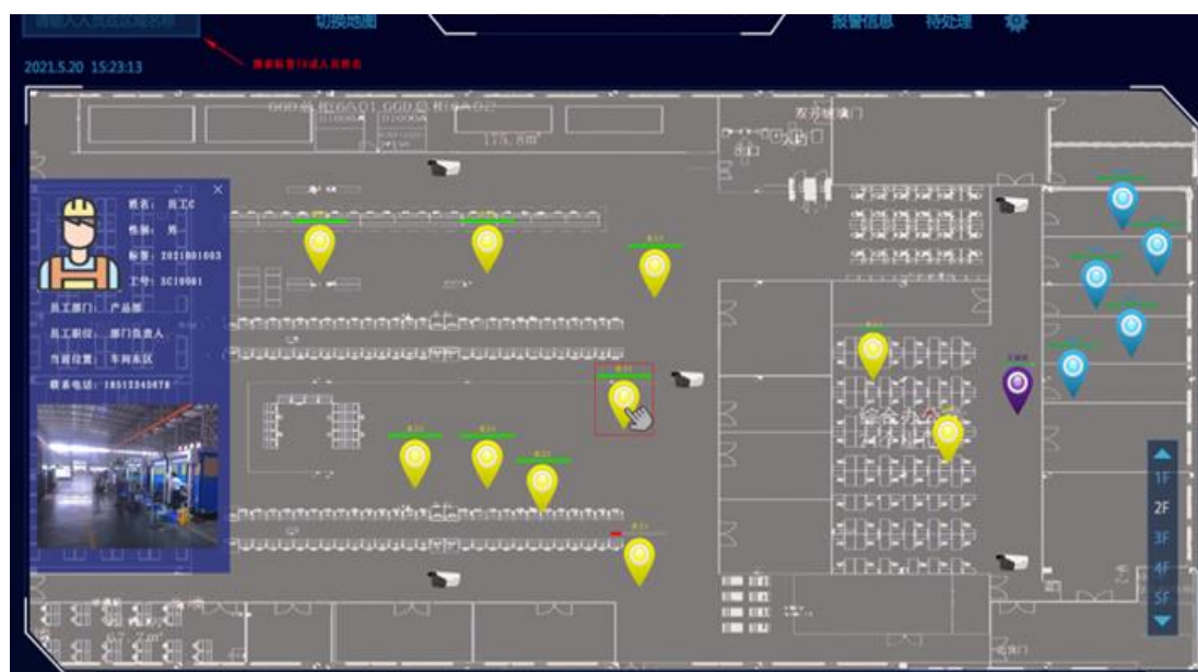
图 59 5G+UWB 高精度定位系统融合视频监控系统
