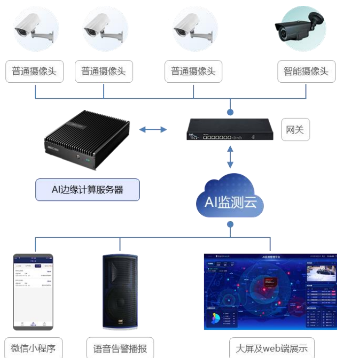
图 39 AI 监测系统架构
