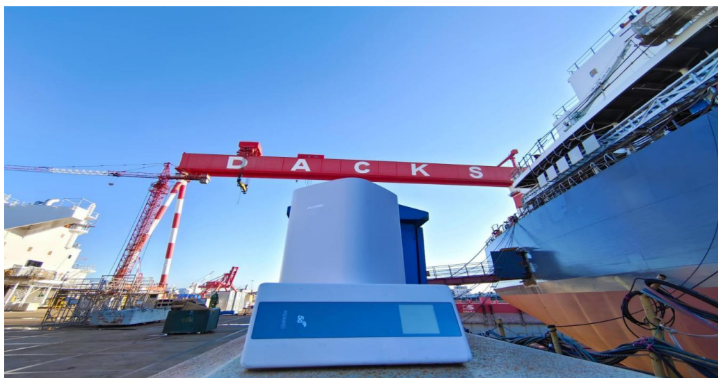
图 62 5G 起重设备监控系统实景
