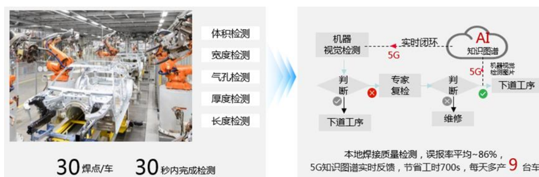
图 116 车身焊点实时检测 2
