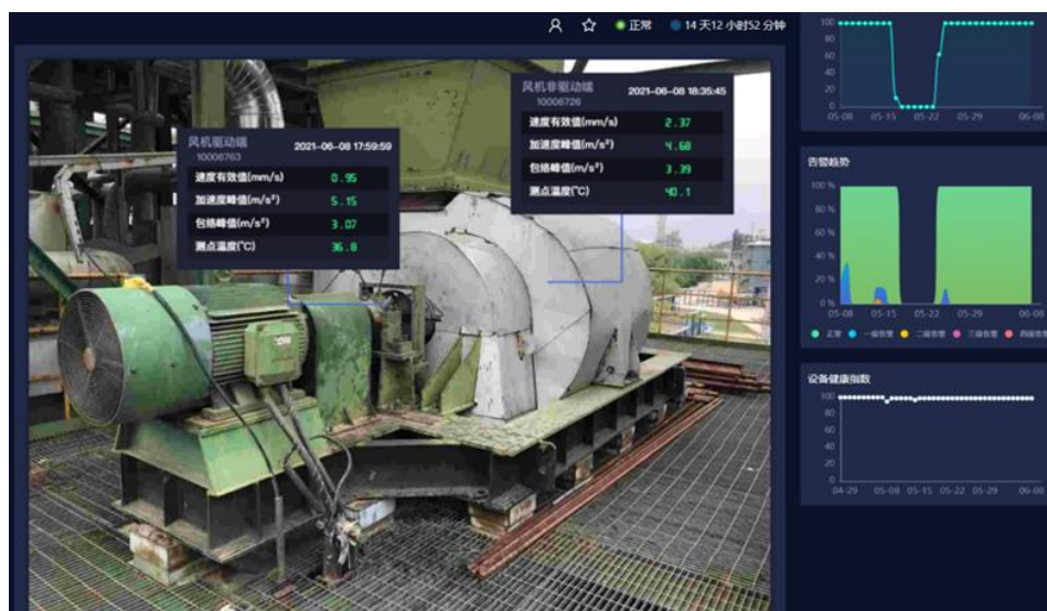
图 125 5G 设备预测性维护平台监测界面 3
