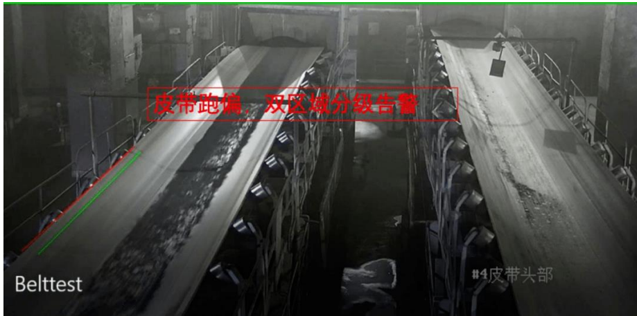
图 53 皮带跑偏检测步骤
