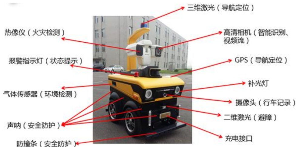
图 114 5G 智能巡检机器人
