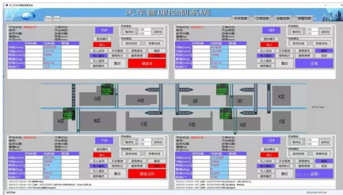
图 4 无人天车四车联动控制平台
